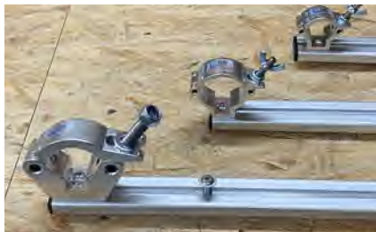
Abb 15 — Konstruktionsprofil Nut 8 in 40x16mm, mit unterschiedlich großen Schellen.
