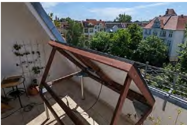
Abb 2 — Der selbstgebaute Solartisch im aufgeklappten Zustand. •
